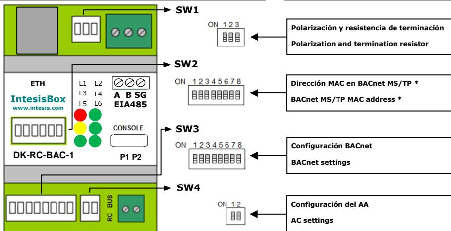
SW1 – Polarización y terminación – Polarization and termination
