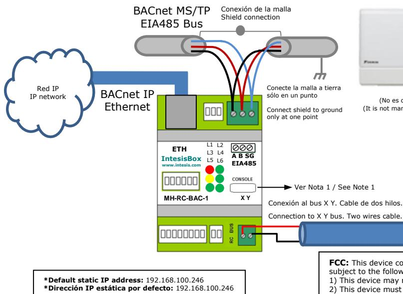
**NOTA 1:** En caso de tener la necesidad de realizar pruebas y no tener acceso al sistema de AA, el Puerto USB se puede utilizar para alimentar el equipo, junto con un alimentador externo USB.
