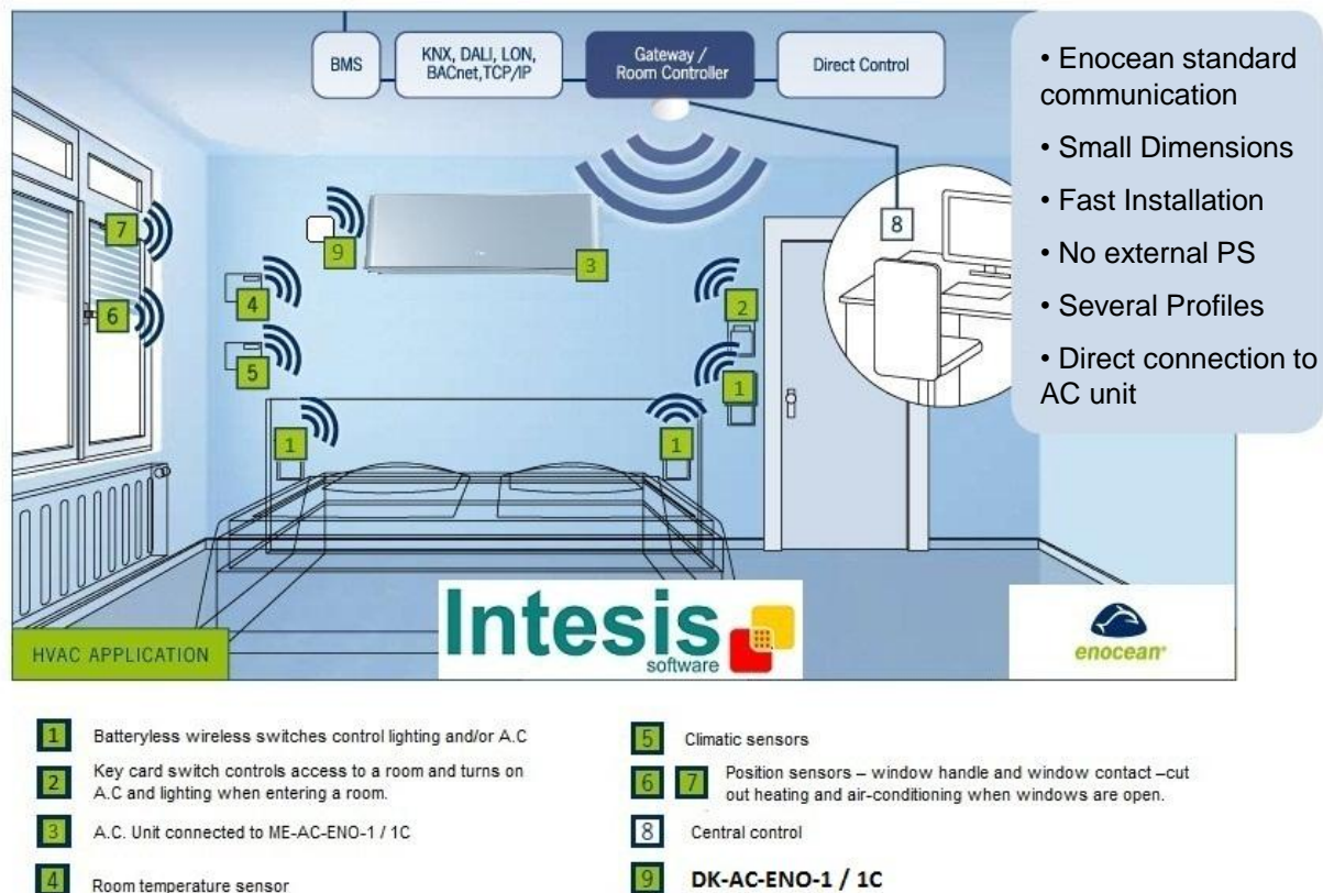
Figura 2.1 Ejemplo de montaje del DK-AC-ENO-1 / 1C en habitación de hotel
