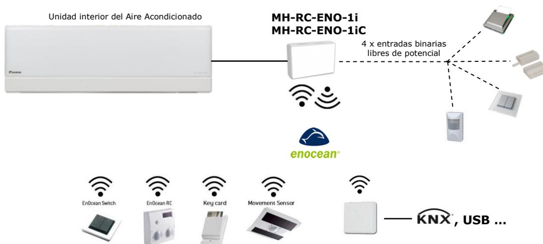
IntesisBox® DK-RC-ENO-1i / 1iC (IntesisBox® a partir de ahora) permite supervisar y controlar, de forma completamente bidireccional, todos los parámetros de funcionamiento de los aires acondicionados Daikin desde las instalaciones EnOcean.
