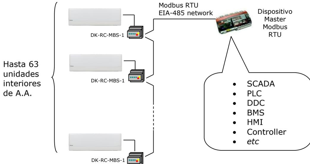
La interfaz DK-RC-MBS-1 permite una integración completa y de forma natural de los equipos de aire acondicionado **Daikin** en redes Modbus RTU (EIA-485). Compatible con todos los modelos de aire acondicionado de la gama doméstica **Daikin**.
