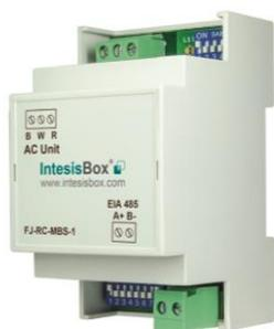
El interfaz FJ-RC-MBS-1 permite una integración completa y de forma natural de los equipos de aire acondicionado **Fujitsu** en redes Modbus RTU (EIA-485).
