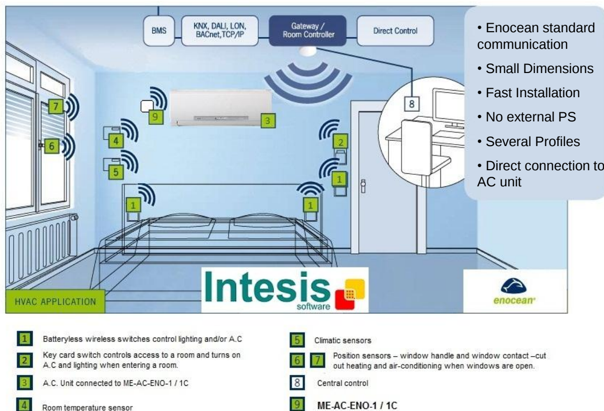
Figura 1.1 Ejemplo de montaje del ME-AC-ENO-1 / 1C en habitación de hotel
