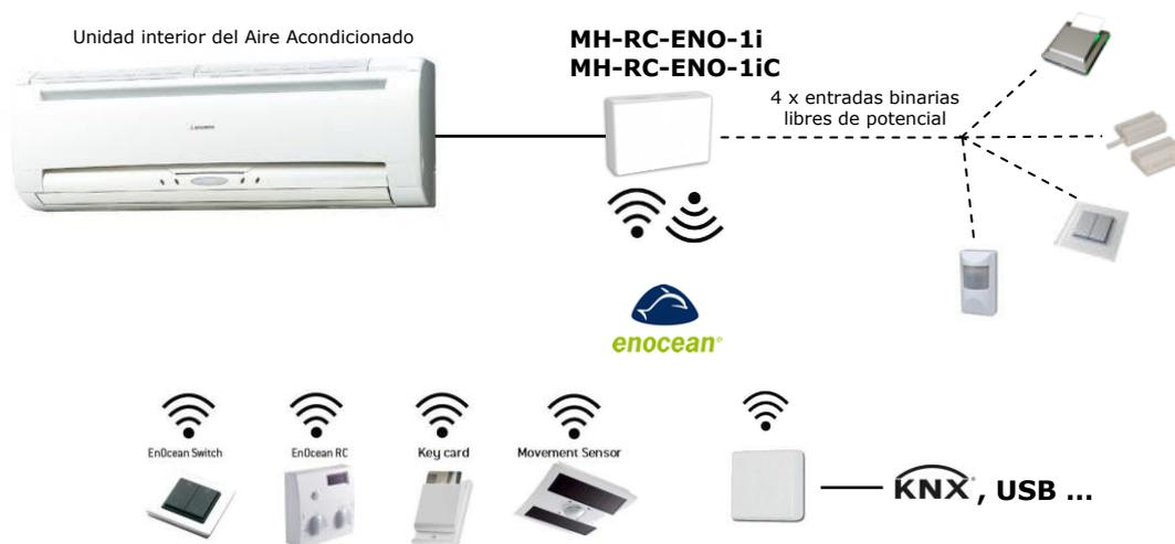
IntesisBox® MH-RC-ENO-1i / 1iC (IntesisBox® a partir de ahora) permite supervisar y controlar, de forma completamente bidireccional, todos los parámetros de funcionamiento de los aires acondicionados Mitsubishi Heavy Industries desde las instalaciones EnOcean.
