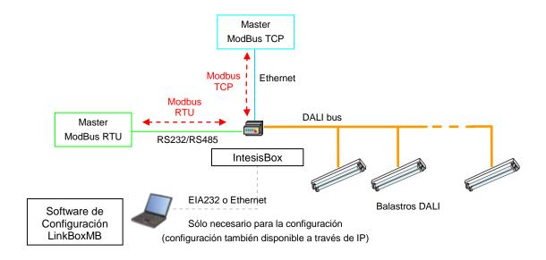
IntesisBox es un dispositivo master DALI, para el control y monitorización de balastros DALI conectados al bus DALI (hasta 64 balastros pueden ser integrados en un sólo canal). IntesisBox también proporciona la alimentación necesaria para el bus DALI.
