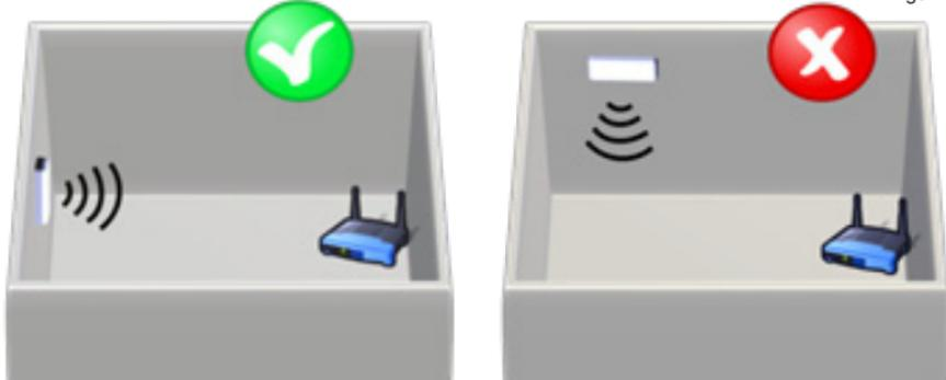
Antennen i vertikal posisjon og peker mot Wi-Fi-tilgangspunktet eller ruteren
