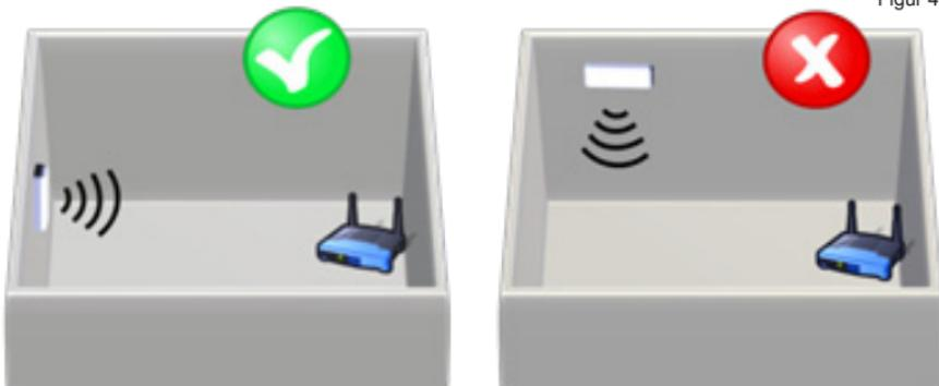
Antennen i vertikalt läge, och så att den pekar mot Wi-Fi-åtkomstpunkten eller -routern
