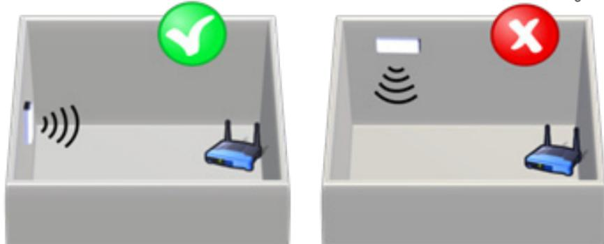
Antena en posición vertical y apuntando al Router o Punto de Acceso Wi-Fi
