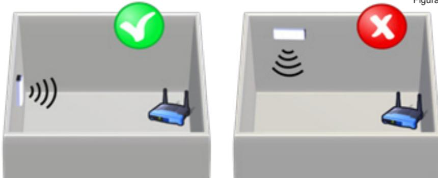
**Antenna in posizione verticale e che punti all' Access Point o al Router Wi-Fi**
