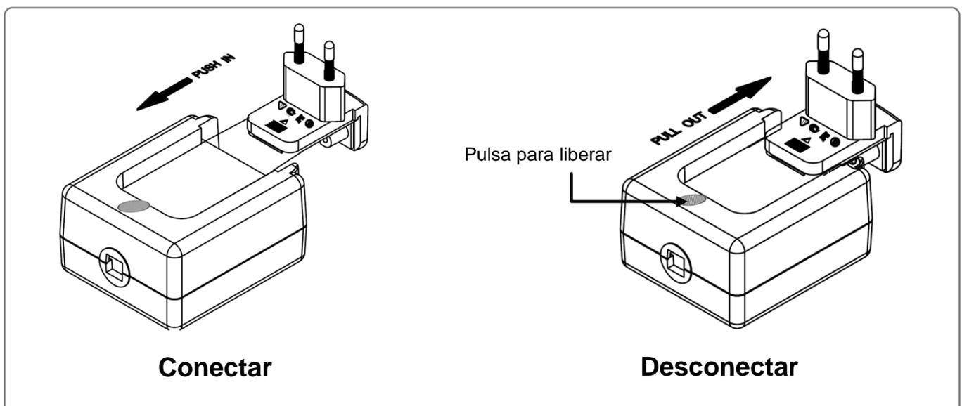
Figura 4-6 Instrucciones para conectar – desconectar el adaptador
