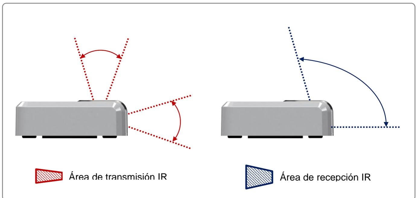
Figura 4-8 Localización de los emisores y receptor IR
